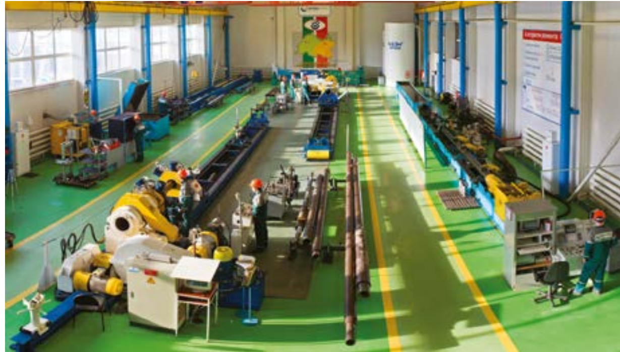
Цех по капитальному ремонту ГЗД
